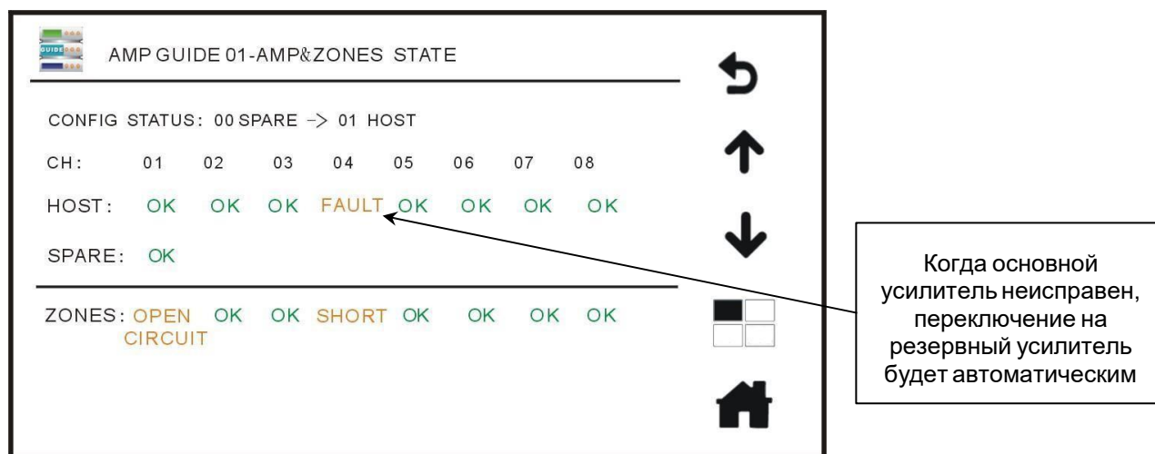
Рис. 4.13. Состояние переключения на резервный усилитель в окне
